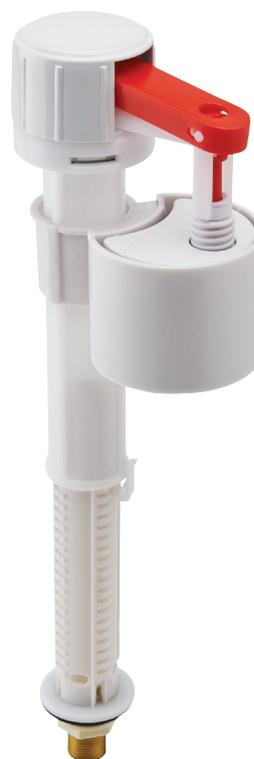
Le robinet F50 est un robinet à alimentation basse universelle. Il possède un embout laiton 3/8". Le robinet est compact et le niveau d'eau peut être ajusté. Le robinet F50 fonctionne avec la technologie servo-valve, qui permet un remplissage rapide du réservoir et une résistance aux pics de pression.
