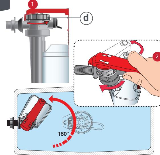
**FR INSTALLATION DU ROBINET :** ① placez le robinet dans le réservoir en levant au préalable l'écrou blanc (b) et ② le visser à l'extérieur du réservoir en le serrant. Utiliser une clé afin de le raccorder à l'arrivée d'eau et serrer avec modération. NB : le joint étant intégré au robinet flotteur, s'assurer qu'il n'y en a pas d'autre avant raccordement à l'arrivée d'eau.
