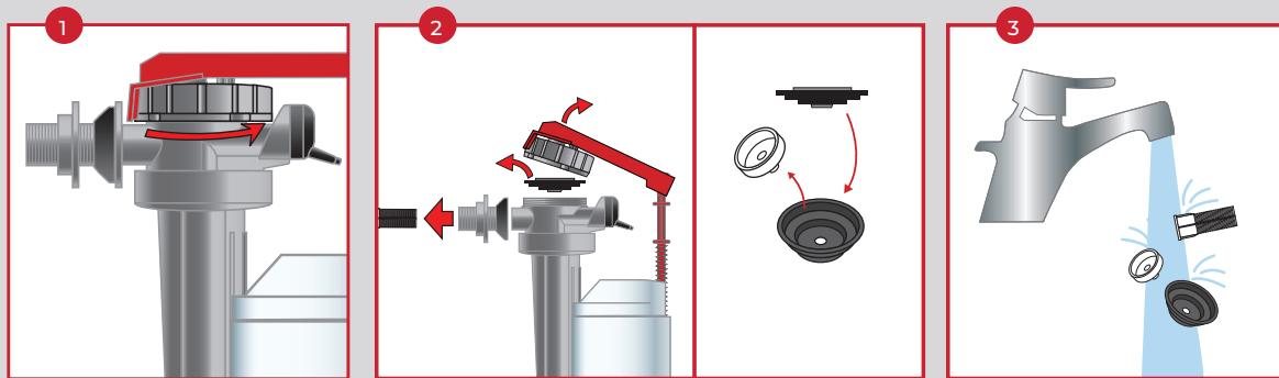
**FR** ENTRETIEN : il est recommandé un entretien régulier de votre robinet ou en cas de fuite. Retirer le joint servo-valve, l'insert et le filtre comme indiqué et passer les sous l'eau savonneuse. Les repositionner immédiatement.
