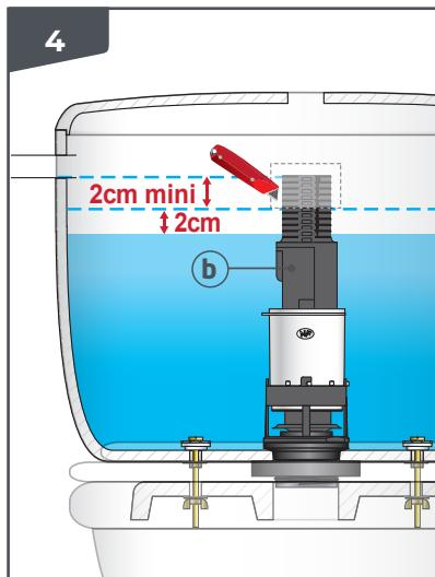
**FR VERIFICATION DU TROP-PLEIN :** ajuster la hauteur du trop-plein (b) en le découplant si besoin, minimum 2 cm au dessus du niveau d'eau et en dessous de l'ouverture pour raccordement du robinet.
