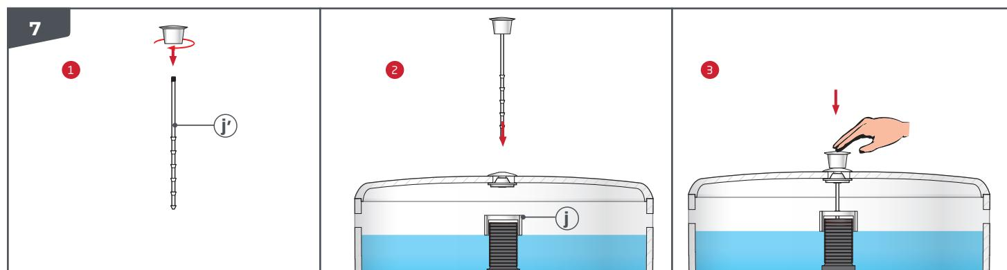
**FR FIXATION DE LA TIROUETTE :** 1 Visser le bouton sur la tige (j). 2 Installer le couvercle et enfiler la tige (j) en s'assurant qu'elle rentre bien dans le cavalier (1). 3 Ajuster ensuite la hauteur de tige en appuyant fermement sur le bouton jusqu'en butée.
