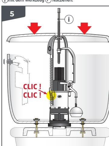
**FR Passer la tige (i) dans le trou du couvercle et poser le en appuyant fermement jusqu'à le fermer.**
