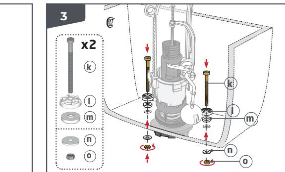
**FR FIXATION DU RÉSERVOIR :** Positionner (k), (l) et (m) à l'intérieur du réservoir et (n) en dessous puis serrer l'écrou (o).
