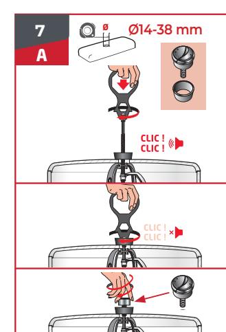
**FR FIXATION DU BOUTON :** 2 possibilités 14-38 (avec bague) et 38-46 (sans bague) tourner la tige (i) à l'aide de la clé (f) fournie jusqu'à ce que la tige tourne dans le vide. Appuyer sur la clé d'un coup franc jusqu'à la butée. Visser le bouton sans forcer.
