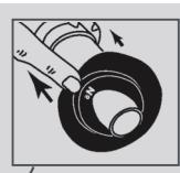
**FR ENTRETIEN :** il est recommandé un entretien de votre mécanisme tous les 5 ans ou en cas de légère fuite. Retirer le mécanisme en tournant 1/4 de tour, enlever le joint comme ci-contre et le nettoyer à l'eau savonneuse avant de le repositionner.
