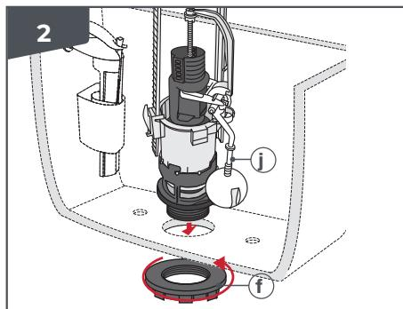
**FR FIXATION DU MÉCANISME :** Placer le mécanisme dans le réservoir en positionnant la partie (j) à l'opposé du robinet. Serrer l'écrou (f) à l'aide de l'outil (e).
