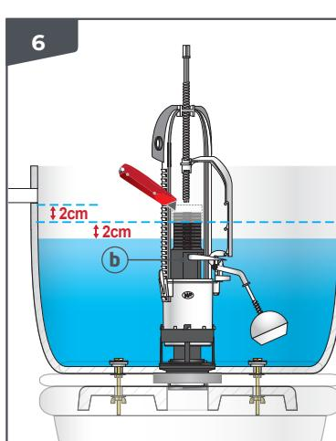
**FR VERIFICATION DU TROP-PLEIN :** s'assurer que le haut du trop-plein (b) est à minimum 2 cm au dessus du niveau d'eau et en dessous de l'ouverture pour raccordement du robinet
