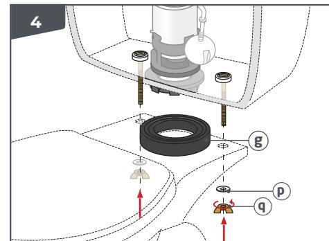
**FR FIXATION DU RÉSERVOIR :** Centrer (g) sur la cuvette. Fixer le réservoir avec les visseries (p) et (q). Serrez fort de manière à écraser le joint (g).
