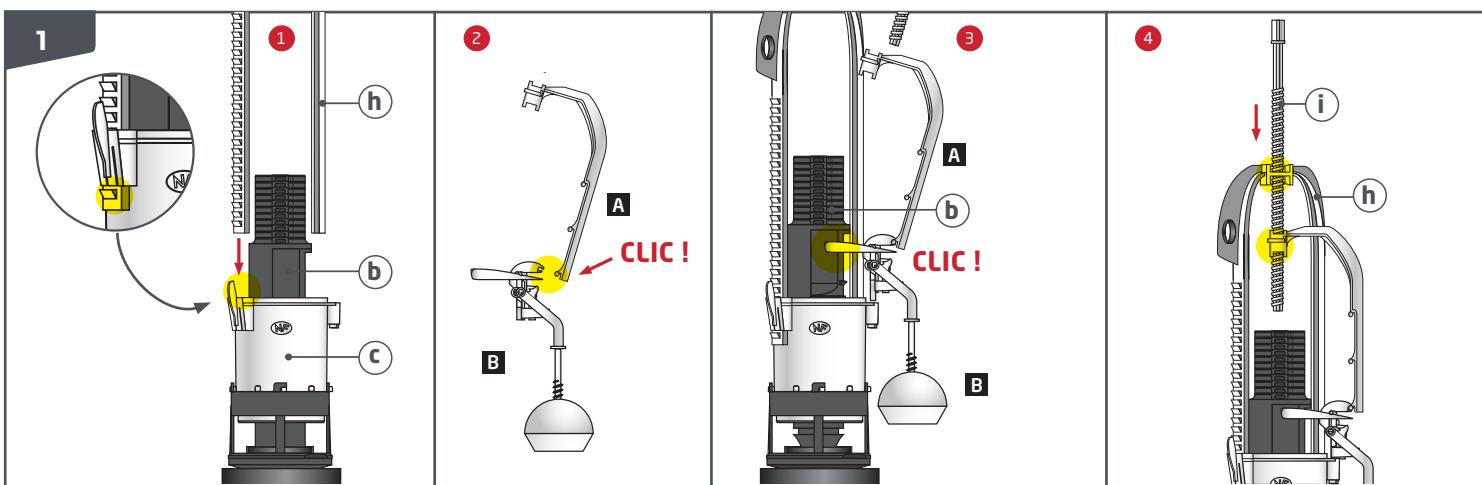
**FR FIXATION DE L'ÉTRIER ET POTENCE:** ① Enclencher l'étrier sur (c) en ne laissant dépasser que d'un seul cran. ② Clipper A sur (b). ③ Puis clipper l'ensemble sur (b). ④ Passer la tige (i) dans le trou de l'étrier (h).
