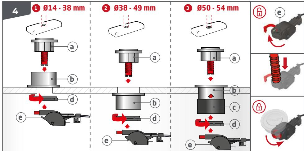
**FR FIXATION DU BOUTON :** en fonction du diamètre de votre trou de couvercle, assembler (a), (b), (c), (d) en suivant les étapes du cas 1, 2 ou 3. Puis ouvrir le clip (e), enfoncez le bouton (a) et refermer le clip (e). Votre bouton est installé. Répositionner votre couvercle sur le réservoir.
