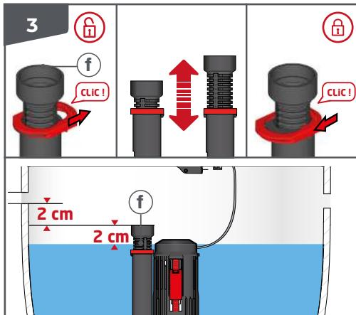
**FR VÉRIFICATION DU TROP-PLEIN :** vérifier que le haut du trop-plein (1) est à minimum 2 cm au dessus du niveau d'eau et en dessous de l'ouverture pour raccordement du robinet. Réglér si nécessaire.
