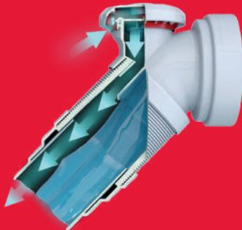
> Quand vous tirez la chasse : une grande quantité d'eau s'engouffre rapidement dans la canalisation. Ce flux crée une dépression (un vide d'air), qui provoque refoulements, bruits et mauvaises odeurs.
