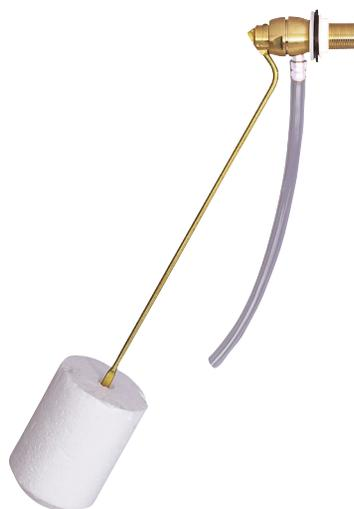
Le F2 de WIRQUIN est un robinet flotteur alimentation latérale utilisant un bras de levier pour fermer l'arrivée d'eau. La quantité d'eau dans le réservoir peut être réglée en fonction des deux niveaux disponibles. Son mécanisme simple n'exige aucun entretien et peut s'adapter à tout réservoir à alimentation latérale. Le F2 supporte les eaux calcaires et fonctionne avec une faible pression au niveau de l'arrivée d'eau.
