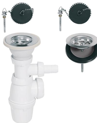
Cet ensemble complet, conçu pour équiper un évier Ø60 2 bacs, comprend 2 bondes, un tube de raccordement, un trop-plein et un siphon classique. Grâce à sa garde d'eau de 50 mm, le siphon est efficace contre les remontées d'odeurs.
