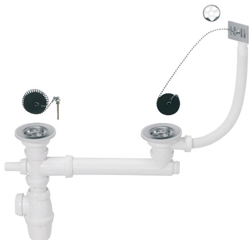
Cet ensemble complet, conçu pour équiper un évier Ø60, 2 bacs, comprend 2 bondes, un tube de raccordement, un trop-plein, et un siphon classique. Grâce à sa garde d'eau de 50 mm, le siphon est efficace contre les remontées d'odeurs.
