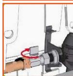
Connexion à l'horizontal au centre du réservoir (latérale ou par l'arrière) pour un maximum d'accessibilité.
