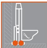
Le bâti IMAGE&OSOL a été spécialement conçu pour les installations sur murs non porteurs. Il se fixe uniquement au sol.
