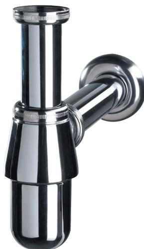
Conçu pour équiper les lavabos et lave-mains, ce siphon en laiton est classique et de qualité. Grâce à sa garde d'eau de 50 mm, il est efficace contre les remontées d'odeurs.
