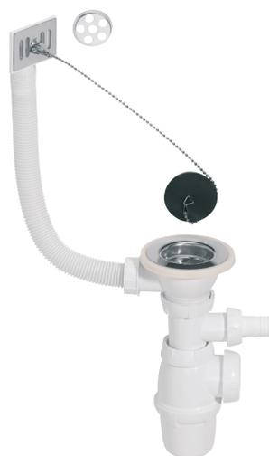
Cet ensemble complet, conçu pour équiper un évier Ø60, 1 bac, comprend une bonde et un siphon classique. Grâce à sa garde d'eau de 50 mm, le siphon est efficace contre les remontées d'odeurs.
